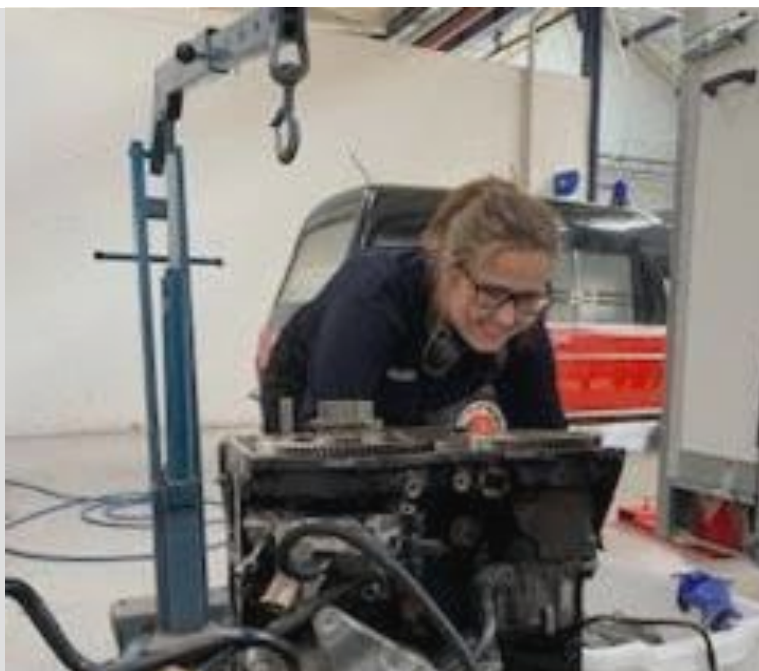
Mercedes Sprinter ātrās palīdzības automašīnas dzinēja renovācija
