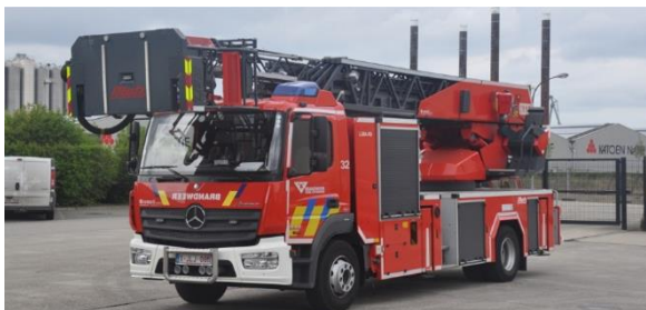
10 ugunsdzēsības mašīnas ir aprīkotas ar līdz 30 m augstām kāpnēm
